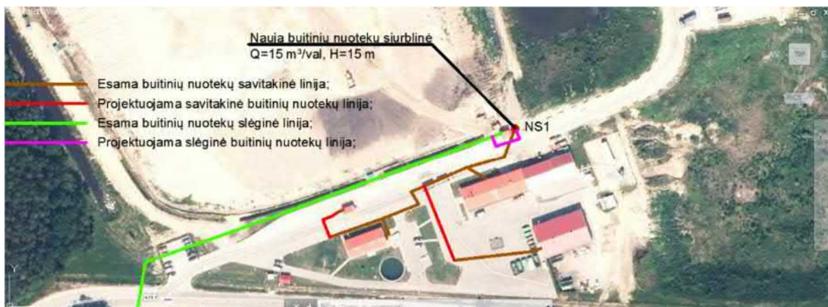
2.5 pav. Planuojamas buitinių nuotekų iš aptarnavimo zonoje esančių pastatų tvarkymo sprendinys
