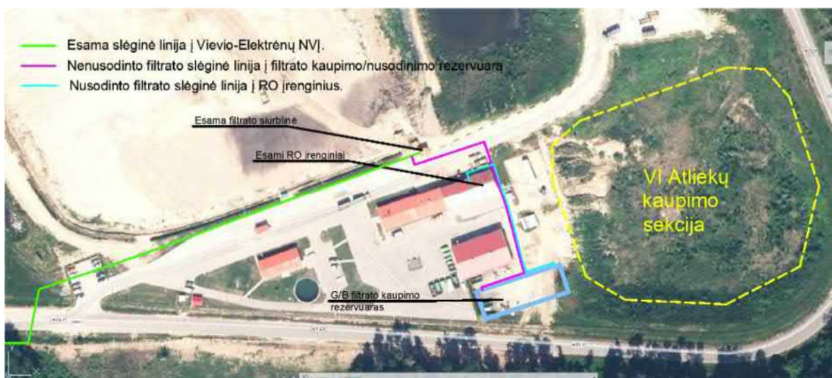
2.9 pav. Planuojamas sąvartyno filtrato tvarkymo sprendinys
