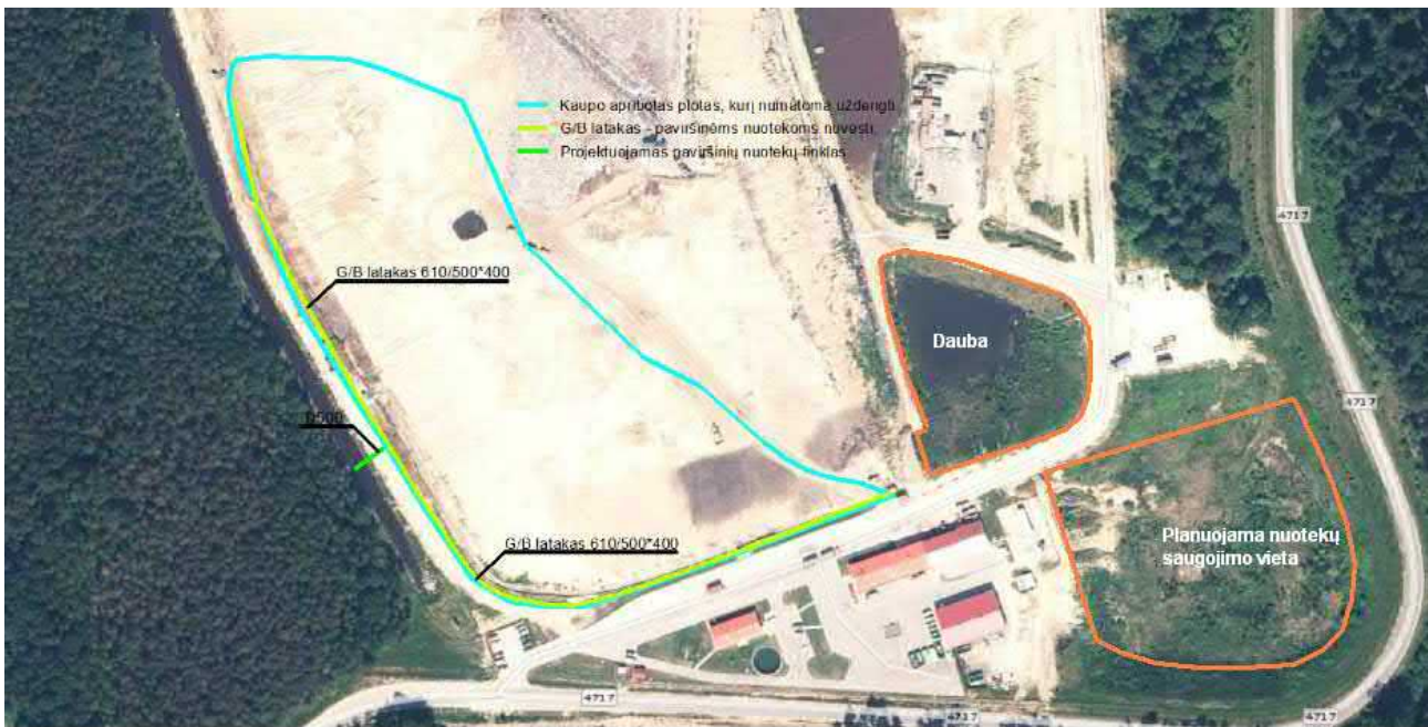
2.7 pav. Planuojamas paviršinių nuotekų saugojimo sprendinys
